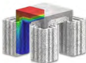
Esempio dell'andamento delle temperature ottenuto con l'analisi termica tridimensionale agli elementi finiti di IsolCupolex®
