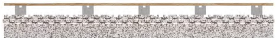
Ventus + OSB fissato con correntini
