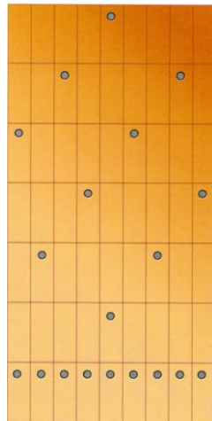
Fig. 1 Schema di fissaggio delle tegole sulla falda per pendenze comprese tra 45 e 60%
