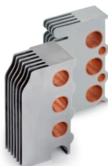
Scambiatore di calore TopGas® Sofisticata combinazione di alluminio ad alta conduttività e rame resistente alla corrosione. TopGas® combi è dotata (dietro) di un ulteriore canale dell'acqua in rame per la preparazione di acqua calda.
